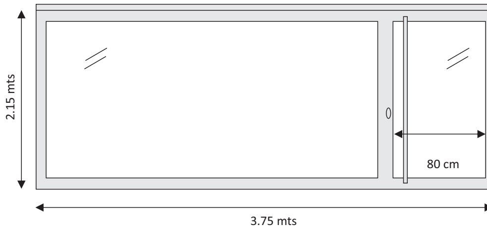
Fig. 24 - ESTRUCTURA DE ALUMINIO Y VIDRIO | REF. INGRESO PRINCIPAL
